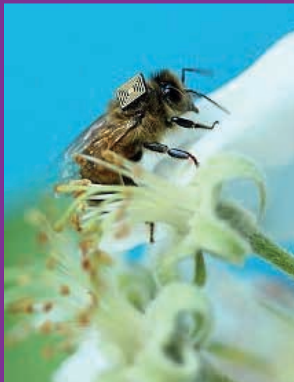
Slika 2. Pasivni RFID tvrtke Hitachi Chemical (dimenzija 2,5 x 2,5 x 0,3 mm) za UHF frekvencijsko područje koji su koristili australski znanstvenici
