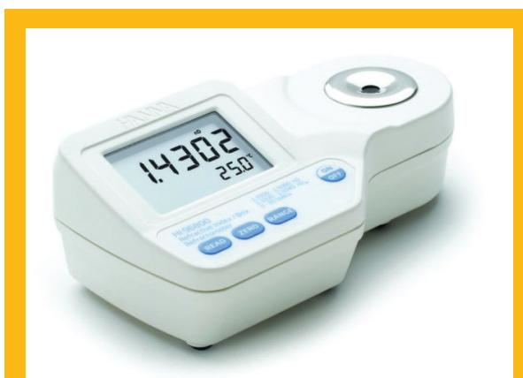
Primjer refraktometara za analizu šećera, fruktoze, glukoze i invertnog šećera analizom mase u vodenoj otopini,
