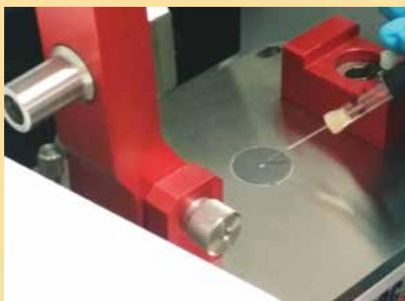
SLIKA 2. UZORAK HEMOLIMFE POSTAVLJEN NA DIJAMANT ATR PLOČE NA FTIR SPEKTROMETRU (IZVOR: HORVATINEC, 2019.)
