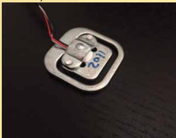
SLIKA 2. MJERNI PRETVORNIK MASE (IZVOR: AUTOR)
