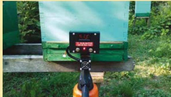
snemo glavni prekidač, koji se nalazi na desnoj strani kutije, i time automatski palimo i ventilator. Kad postignemo temperaturu od 180 Celzijevih stupnjeva, smanjimo plin na minimum te otvorimo poklopac čahure i stavljamo gram oksalne kiseline po nastavku i zatvaramo poklopac.
