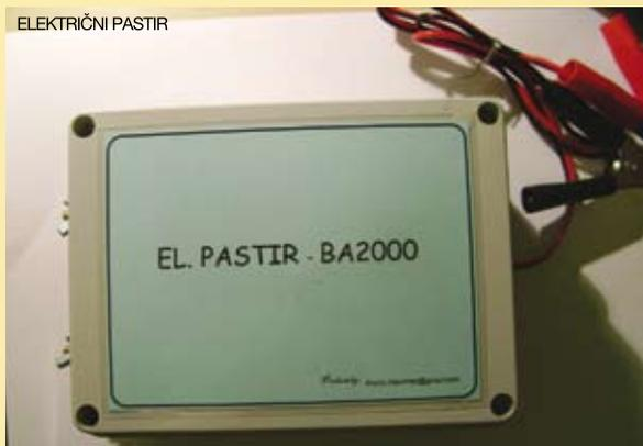
Više je vrsta pastira, ovisno o napajanju baterijom (9 V / 12 V ili 220 V, kada nam je pčelinjak u blizini kuće, što je doduše rijetkost), zatim o snazi, što pak ovisi o duljini ograde, te o visokonaponskom elementu (VN transformatoru, kod nekih je samogradnji upotrijebljena bobina iz automobila) i slično.
