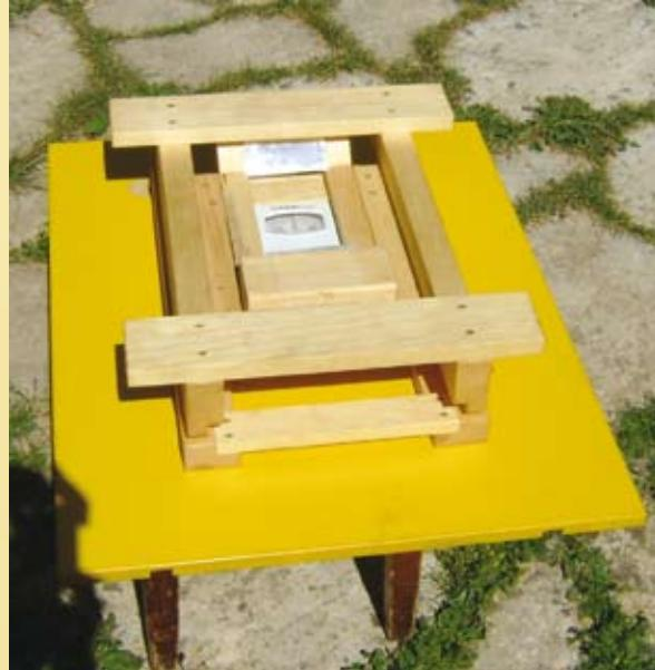
Pčelarska vaga po Siminom naputku može se napraviti uz malo novca. Drveni elementi su napravljeni od jelovog drva, a sama vaga je vaga za osobnu upotrebu kupljena u prodavaonici. Prva slika prikazuje osnovu vase sa pojedinim dijelovima.
