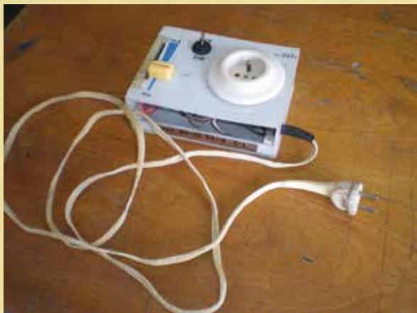
dvostruko više od snage moje bušilice (780 W). Regulator sam izvadio i spajajući žice probao sam spojiti napajanje od 230 V (volti) regulatorom i utičnicom bušilice. Vrlo jednostavno, ali je funkcionalo.
