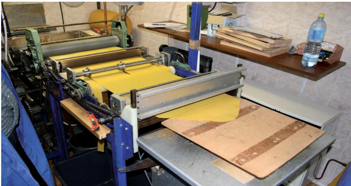
tekući vosak, dobiva se prva traka voska za daljnju preradu debljine oko 4-5 mm. Tako namotan vosak na bubenju spreman je za nastavak prerade, odnosno za završnu izradu satnih osnova. Ovaj dio faze, ujedno im je i "usko grlo" cijelokupne proizvodnje, te najavljuju njegovu skoru modernizaciju.
