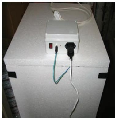
Sastavljena komora. Na poklopcu se nalazi elektronički termostat (vlastita izrada), na kojem je priključnica za senzor i priključnica za napajanje grijača.
