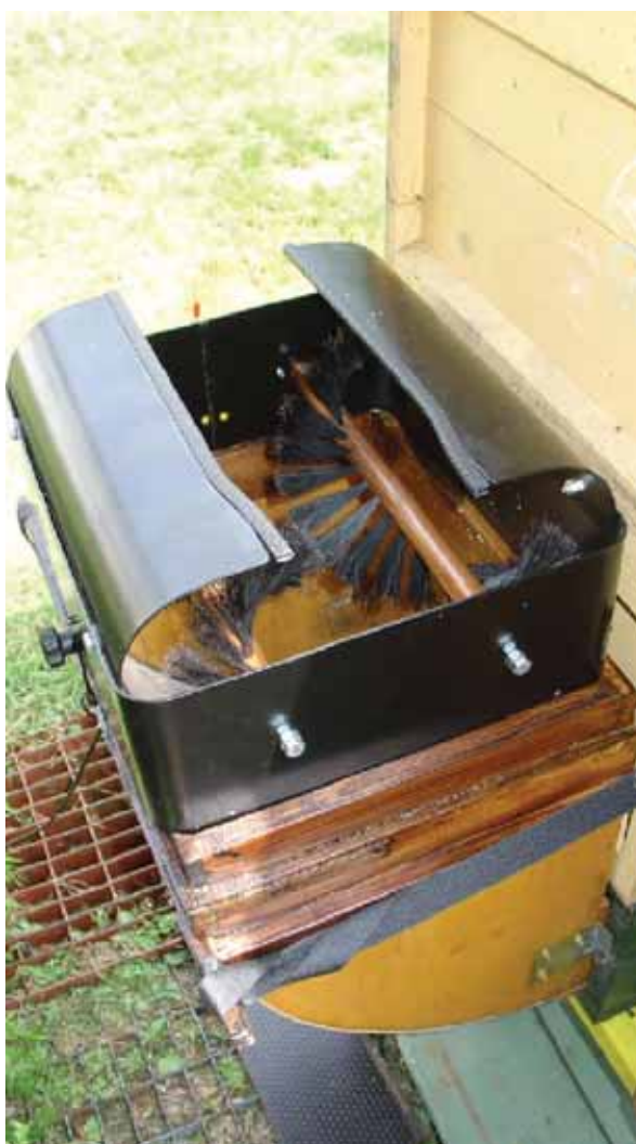
Slika 2. Metalna ploča je L profila, pričvršćena na skupljač pčela, koji se pričvrsti za vijak na podnici.
