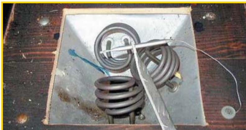
Iznad motora su tri grijaća od 150 W, koji zagrijavaju zrak, koji suši namirnice koje namjeravamo posušiti. (Foto: B. Obranović)
